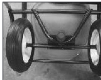
Figure 7 – Rotate Pivot Mount Plate to wheelbarrow stowed position Figura 7. Gire la placa de montura del pivote hacia la posición guardada de carretilla.
